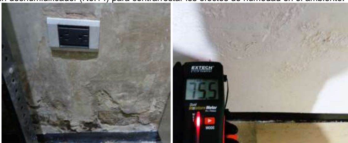
Imagen: indicadores de humedad en el muro oriental de la reserva de prensa después del 27 de noviembre.
