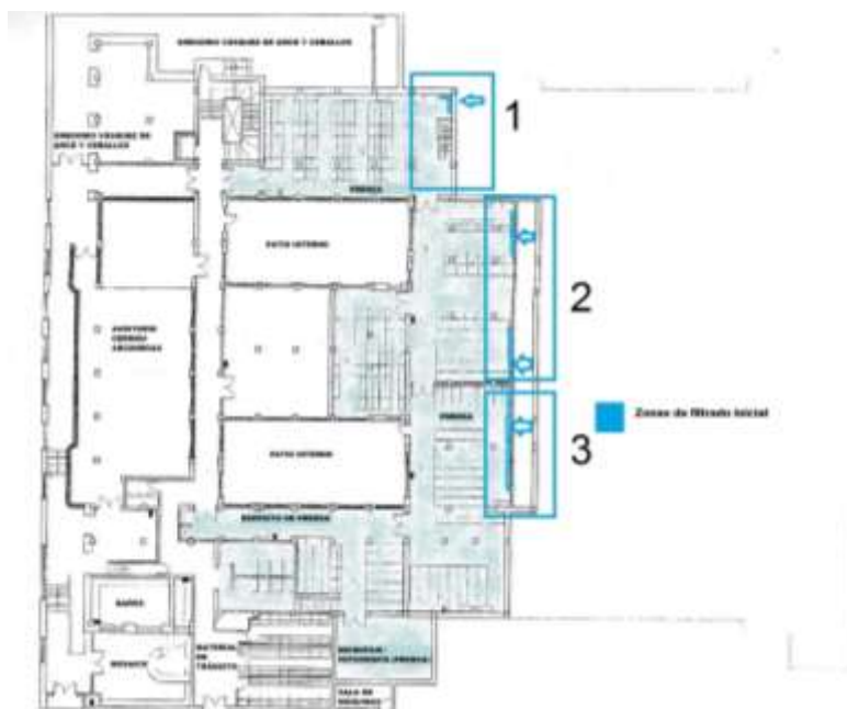
Plano 3: zonas de filtración inicial durante 2010 - 2022 y 2023. Los números indican el orden en el que empezó a evidenciarse la inundación durante 2022 y 2023 (de norte a sur).
